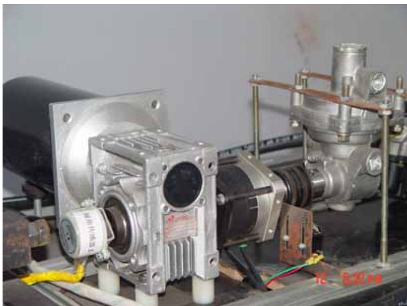
图 3-1 旋转促动机构
