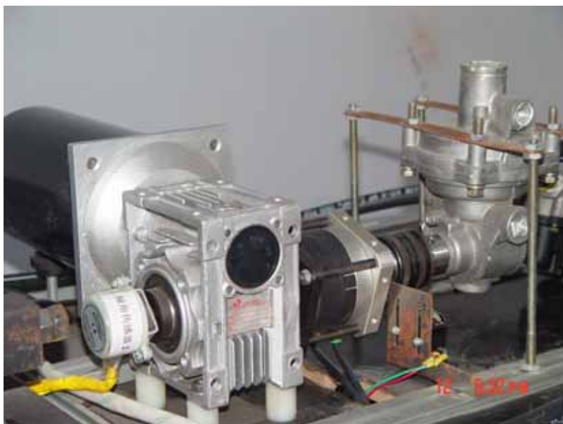
图 3-1 旋转促动机构
